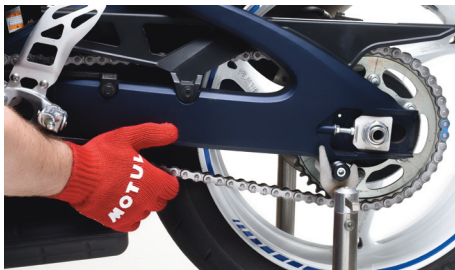
> Proverite ugibanje sekundarnog lanca
