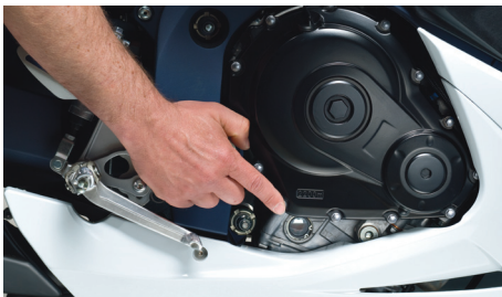
➤ Proverite nivo ulja preko kontrolnog stakla
